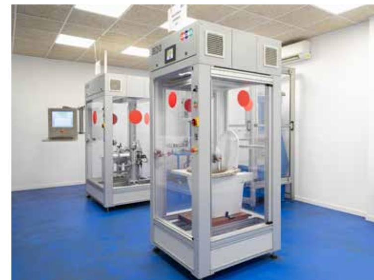
En els bancs d'assaig de durabilitat i resistència es posen a prova les tapes i seients.
