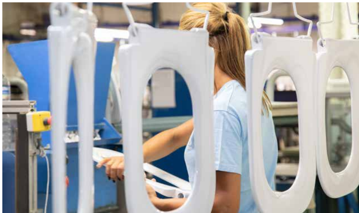
Línia de pintat automatitzada, dissenyada pels tècnics de Comsan per optimitzar l'espai, el consum de pintura i la capacitat de producció.
