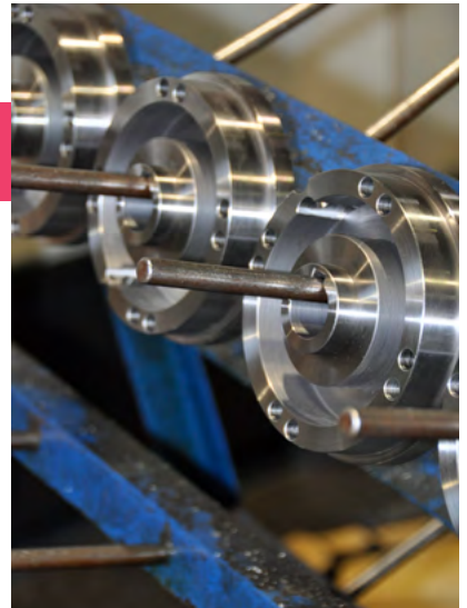
Un dels components interns d'un embragatge electromagnètic ELAM20/CD, acabat de mecanitzar i preparat per al muntatge.
