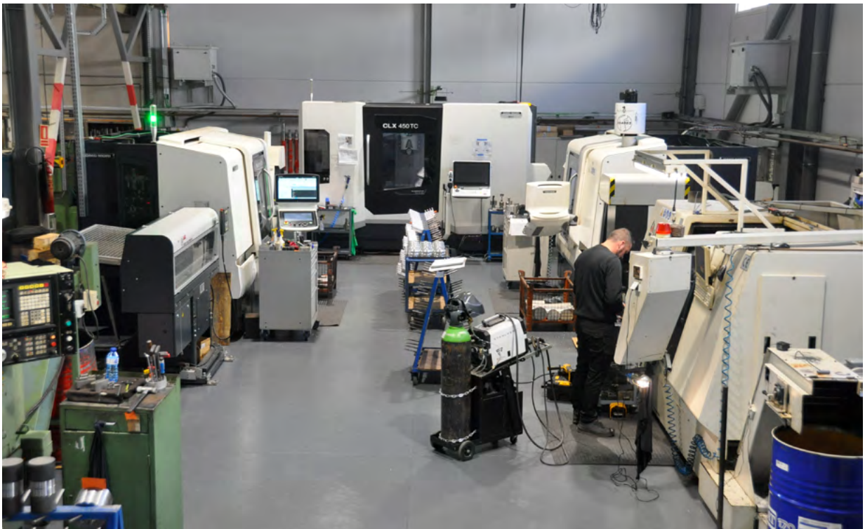
Àrea de mecanitzats CNC de la planta de Castellar del Vallès, amb màquines eina en diversos formats destinades a la producció seriada dels components i recanvis. Al fons, el centre de mecanitzat de més capacitat, en funcionament des de novembre de 2025.
