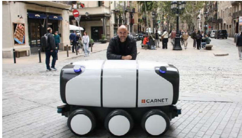
Dins el projecte municipal BotNet ha començat a funcionar a Barcelona el robot Ona, un vehicle elèctric autònom de repartiment de paqueteria a distàncies curtes.
