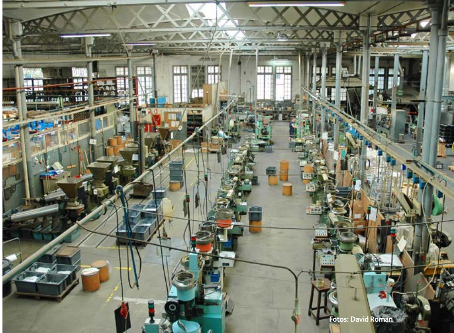
A la nau dedicada a muntatges s'hi arregen les màquines que duen a terme l'acoblament dels diversos components dels botons i fermalls, així com les destinades al treball del filferro d'inoxidable i llautó.
