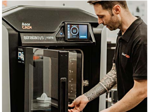
La impressora 3D F370 de Stratasys, permet fabricar peces prototip i funcionals tant per a utilitatges com per a producte final. Precisió i repetibilitat són les seves millors característiques.
