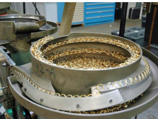
Els lots de producció d'Indústries Waldes poden voltar el milió d'unitats. En la fotografia, les molles interiors dels botons de pressió.
