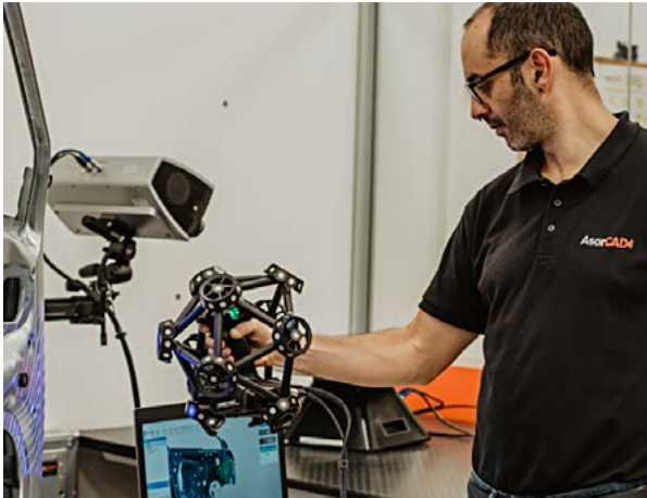
Equip MetraSCAN de Creaform per a mesuraments de precisió en volums grans. Precisió de l'equip 0,025 mm.
