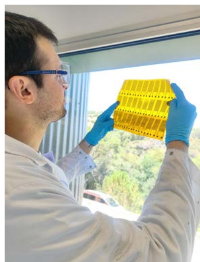
Un investigador avalua a contrallum la resolució d'elèctrodes impreses amb tinta de carboni, mitjançant serigrafia, sobre un substrat flexible, per a la fabricació de sensors de temperatura que s'acoblaran a les cèl·lules elèctriques.
