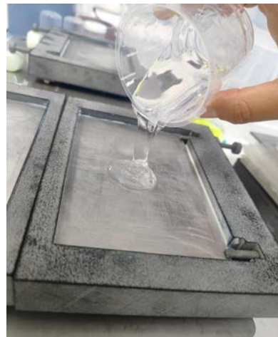
Recobrint d'una cèl·lula elèctrica amb una resina de silicona, que formarà part del sistema de control de temperatura. La resina s'aboca sobre un motlle on està encaixada la cèl·lula per obtenir-ne capes amb un gruix controlat.
