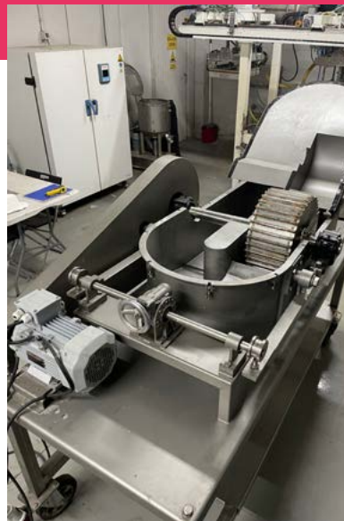
Aquesta pila holandesa presta serveis a les instal·lacions de TS Innovació.
