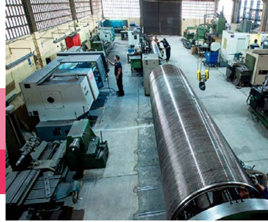
La indústria paperera requereix maquinària i instal·lacions de mecanització i caldereria adequades. En primer pla, un bombo transformador en procés de reparació.
