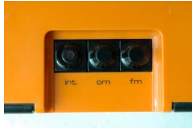
L'interruptor i els commutadors de banda són fàcils d'accionar i s'integren perfectament en la línia de la carcassa.
