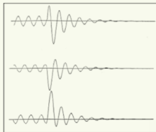
Aportació d'un motor d'inducció en les seves tres fases. Font: ANSI/IEEE 551-2006.
