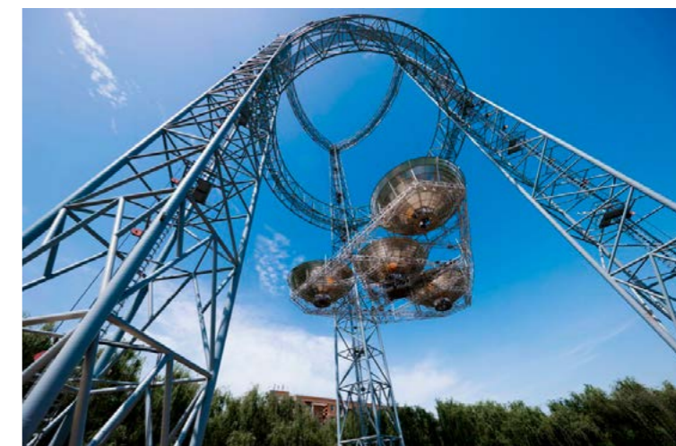
Instal·lació a la Universitat de Xidian del projecte d'estació de captació d'energia fotovoltaïca amb plafons situats a l'espai.
