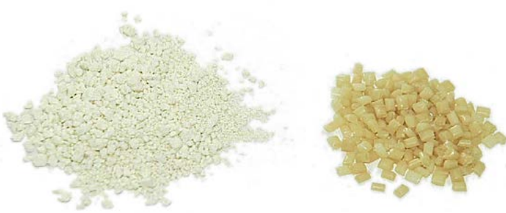
A l'esquerra, el PHA produït pels bacteris després del procés d'extracció. A la dreta, la gransa additivada, preparada per injectar.
