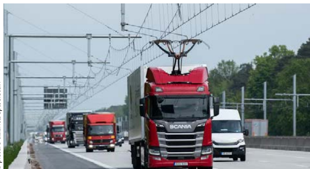
Primera autopista elèctrica a Alemanya, construïda el 2019. A sota, carril bici amb plaques solars a Corea del Sud.
