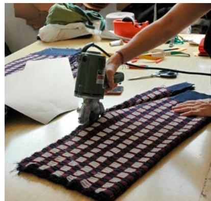
La longitud de les peces teixides es calcula en funció del patronatge i les talles per tal de minimitzar la pèrdua. Les diferents peces es tallen manualment.
