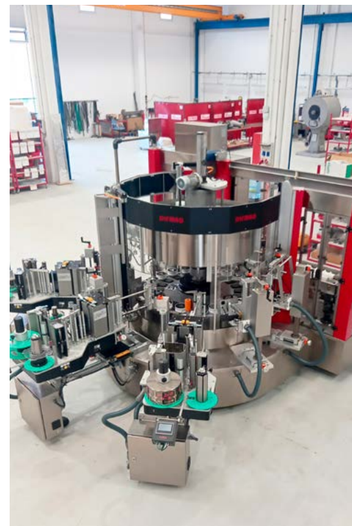
Una etiquetadora Opentech 1200 amb tres estacions d'etiquetatge i equipada amb visió artificial. L'estructura d'aquesta etiquetadora facilita l'accessibilitat als operadors i redueix el temps dedicat a l'ajust i els canvis de format.
