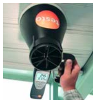
Medida en Conductos con aspiración
