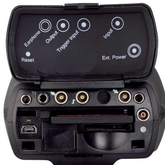
Fig 3. Base de un analizador que muestra los conectores externos
