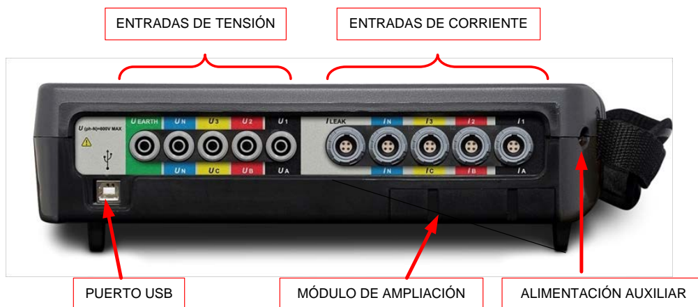
Fig. 2-3.- Conexiones parte superior del AR6
