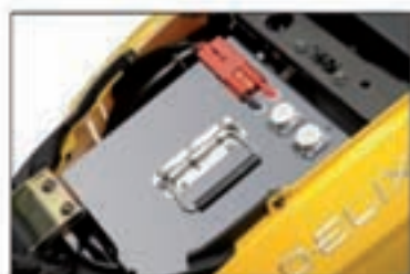
Bateria extraïble de liti amb sistema de control BMS.
