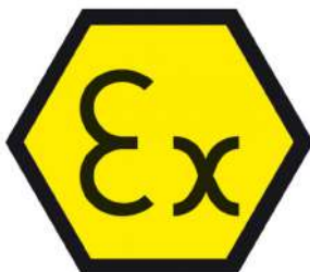
Fig. 16. Ejemplo de señal utilizada para marcar equipos que cumplen requisitos específicos y tienen una certificación contra atmósferas explosivas.
