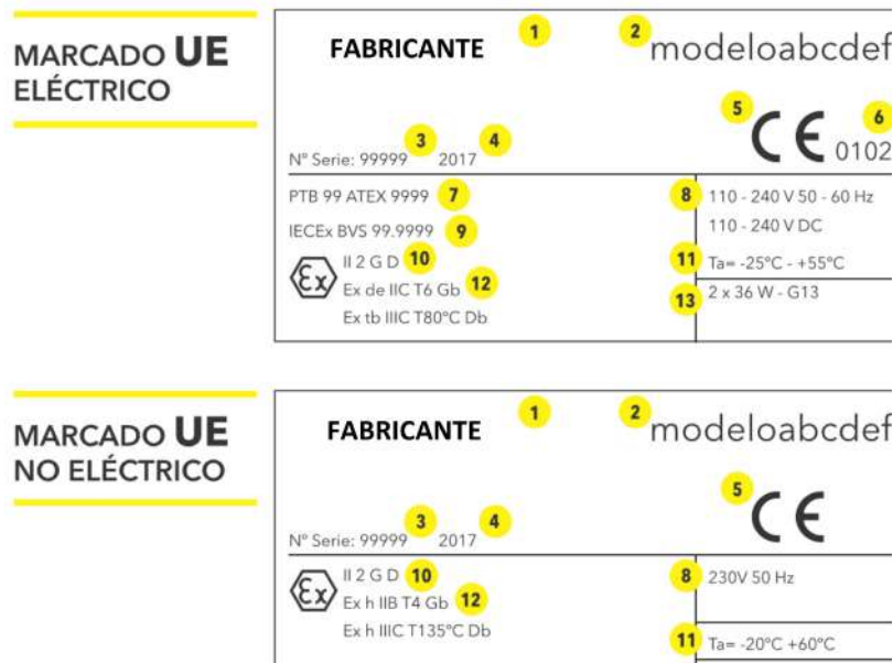
Fig. 20. Placas de equipos marcados ATEX eléctricos y no eléctricos
