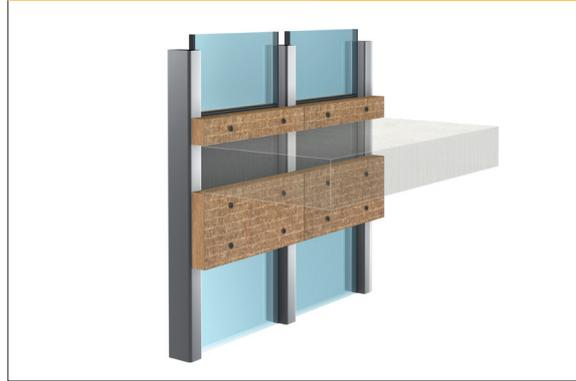
El sistema Conlit MC es una barrera cortafuegos para fachadas ligeras del tipo muro cortina. Se aplica en el encuentro de este con el canto de forjado, al objeto de limitar el riesgo de propagación exterior de fuego y humos. El sistema Conlit FP es una barrera cortafuegos para fachadas ligeras del tipo fachada panel y se aplica en el encuentro de esta con el canto del forjado.
