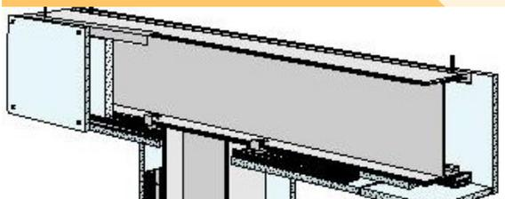
Las estructuras de acero requieren de una protección especial al fuego según su masividad. Con placa Knauf Cortafuego puede proteger desde R15' hasta R180'.
