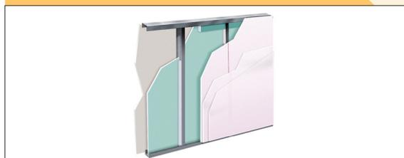
Sistema Shaftwall para la compartimentación de huecos de ascensor con resistencia al fuego de hasta EI 180 por las dos caras.
