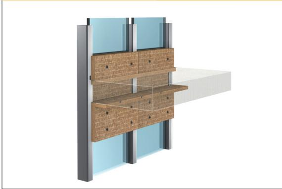
Es una franja horizontal de 1 metro de ancho, EI60. Este sistema puede estar compuesto por dos paneles Conlit 150 AF, o un panel Conlit 150 P y un panel Conlit 150 AF en la cara visible, de 30 mm de espesor cada uno. Se halla fijada a la medianera con una estructura auxiliar.
