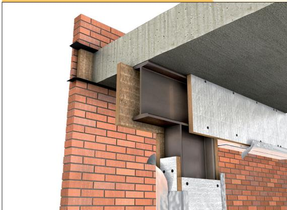
Son la solución para la protección contra el fuego de estructuras metálicas. Consiste en revestirlas con paneles de lana de roca Conlit 150 P (o Conlit 150 AF), con espesores que van en función de la masividad de los perfiles a proteger y de la estabilidad al fuego (R) requerida.
